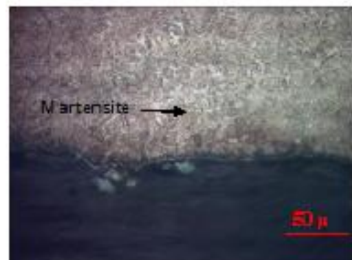
Gambar 8. Struktur Mikro Permukaan Luar Baja SAE 1040 Diameter dalam 30 mm dengan pembesaran 400X memiliki fasa Martensite.
